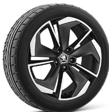
18" kola z lehké slitiny Comet černá leštěná* disk: 7,5J × 18" ET48 pneu: 225/45 R18
