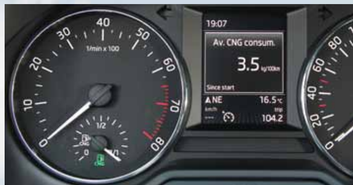
Rozsvícená zelená kontrolka v ukazateli množství plynu v nádržích indikuje u modelů Octavia G-TEC a Octavia Combi G-TEC režim, kdy vůz spaluje CNG.
