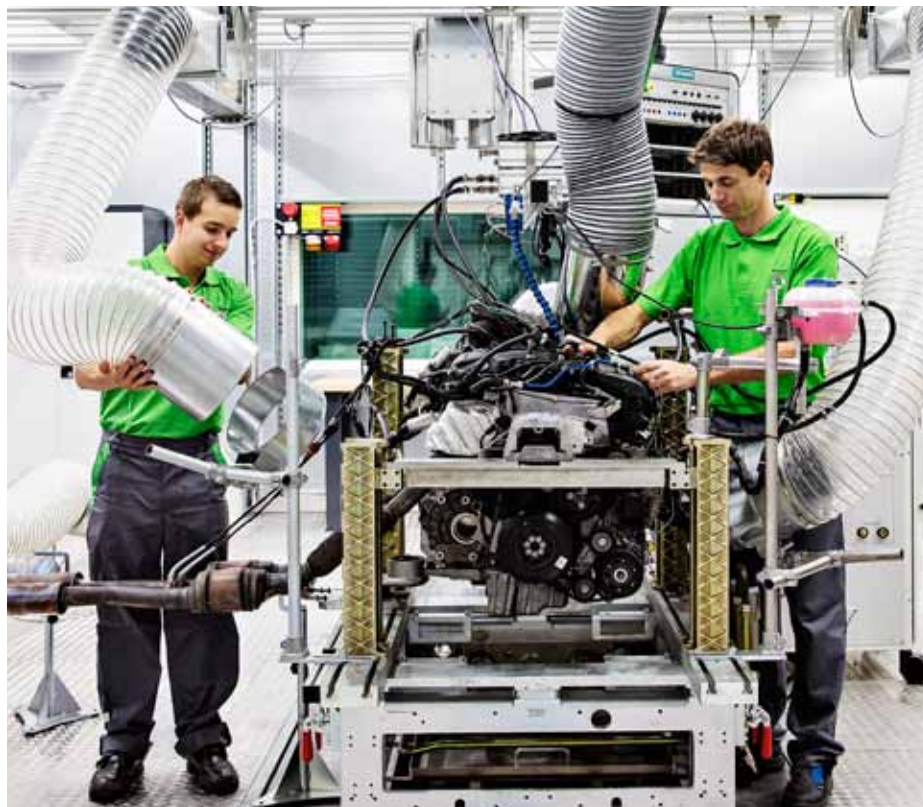
Instalace a zprovoznění motoru na brzdovém stanovišti.
