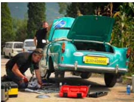
Jediná oprava Felicie – bylo nutné rozhybat zatuhlý brzdový váleček.
