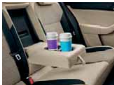
Držáky nápojů v zadní loketní opěrce. Za ní je otvor pro převoz dlouhých předmětů.
