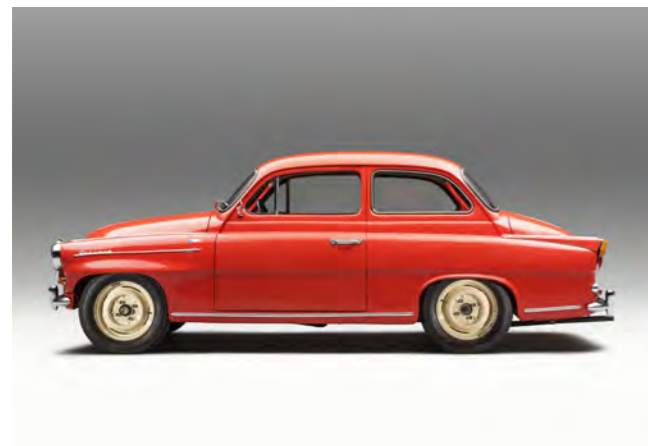
↑ ŠKODA OCTAVIA TS existovala ve dvou variantách – TS s motorem o objemu 1 089 cm 3 s výkonem 50 koní a TS 1200 s motorem o objemu 1 221 cm 3 a výkonem 55 koní
