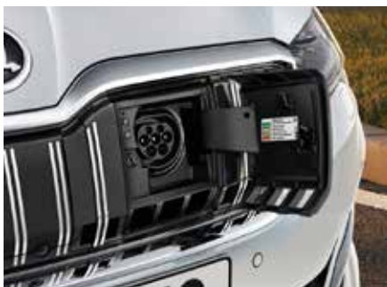
Nabíjecí port je v plug-in hybridním modelu SUPERB iV umístěn v masce chladiče.
