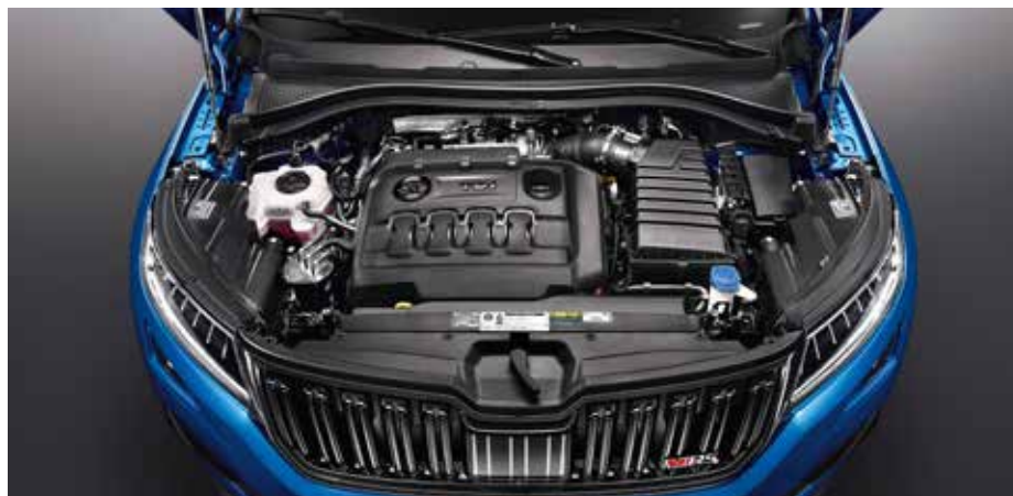
Unikátní vznětový motor přeplňovaný dvojicí turbodmychadel s nestejnou velikostí zaujme výkonem 176 kW (240 k) a především točivým momentem 500 Nm.
