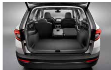
ZAVAZADLOVÝ PROSTOR má v kombinaci se zadními sedadly VarioFlex základní objem až 588 l, který lze zvětšit na 1810 l.
