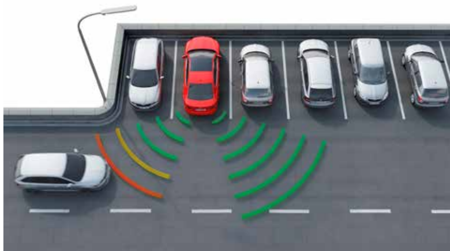
Asistent pro vycouvávání z parkovacího místa informuje o přítomnosti cizího vozidla šikmo za vozem. K jeho identifikaci slouží ultrazvuková čidla.
