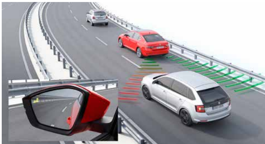
Novinkou nabídky značky ŠKODA je v novém Superbu systém monitorování mrtvého úhlu zpětných zrcátek. Řidiče o přítomnosti vozidla v tomto prostoru informuje kontrolka umístěná v odpovídajícím zrcátku.
