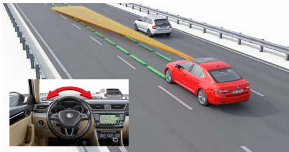
Systém udržování v jízdním pruhu pomocí čelní kamery a zásahů do řízení pomáhá řidiči jet uprostřed jízdního pruhu. Jde o asistenční systém, nikoliv o systém automatického řízení.
