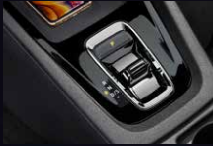
Ovládání automatické převodovky DSG se provádí minimalizovaným elektronickým voličem umístěným mezi sedadly.
