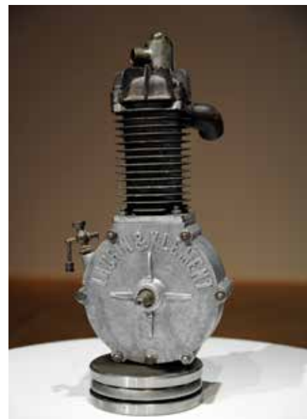
Motocyklový motor Typ 1 1/4 hp o objemu 211 cm 3 z roku 1899 s výrobním číslem 16! Továrna současně představila i slabší motor Typ 1 1/4 hp.
