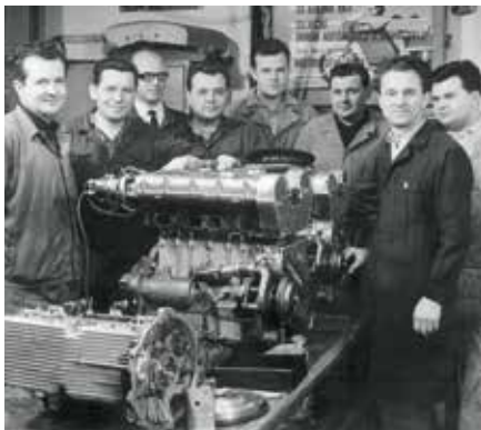
V Česane postavili v roce 1958 čtyři motory ŠKODA 1100 OHC o výkonu 92 k pro dva spidery a dvě kupé.
