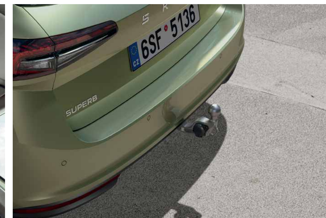
Tažné zařízení sklopné, elektricky odjistitelné
