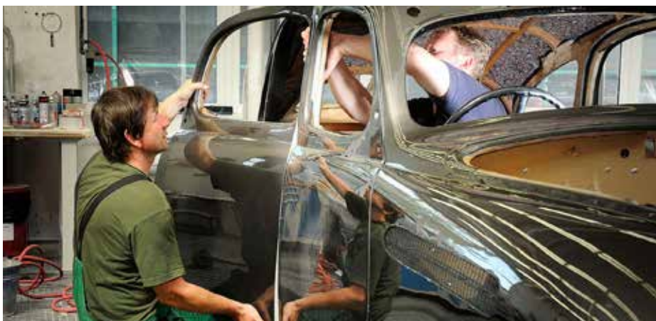
Skelet karoserie prototypu ŠKODA 935 Dynamic byl vyroben ze dřeva, povrchové díly pak z hliníkového plechu. Na snímku je zachycen vrchní restaurátor Josef Petříček.
