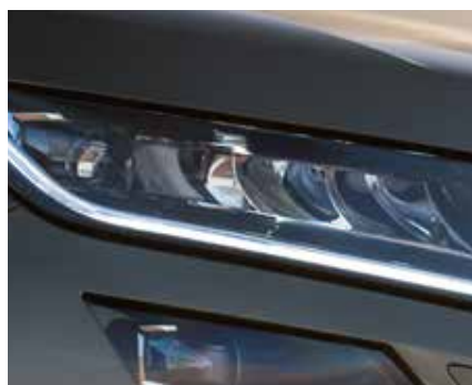
Přední světlomety mohou být poprvé vybaveny výhradně LED světelnými zdroji, jejich barva se blíží dennímu světlu, které je příjemné pro lidské oči.
