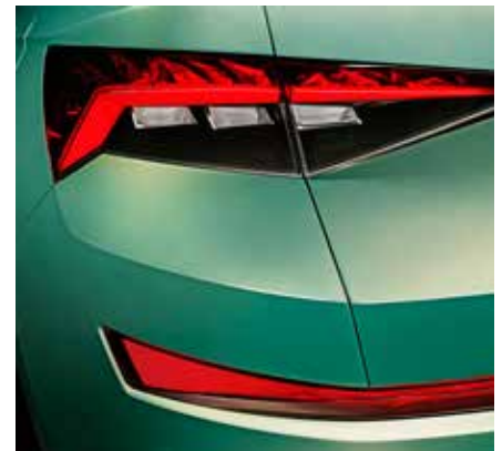
Jednoznačně vedené linie nechávají vyznít souhru světla a stínu. Zadní svítilny konceptu používají technologii LED.
