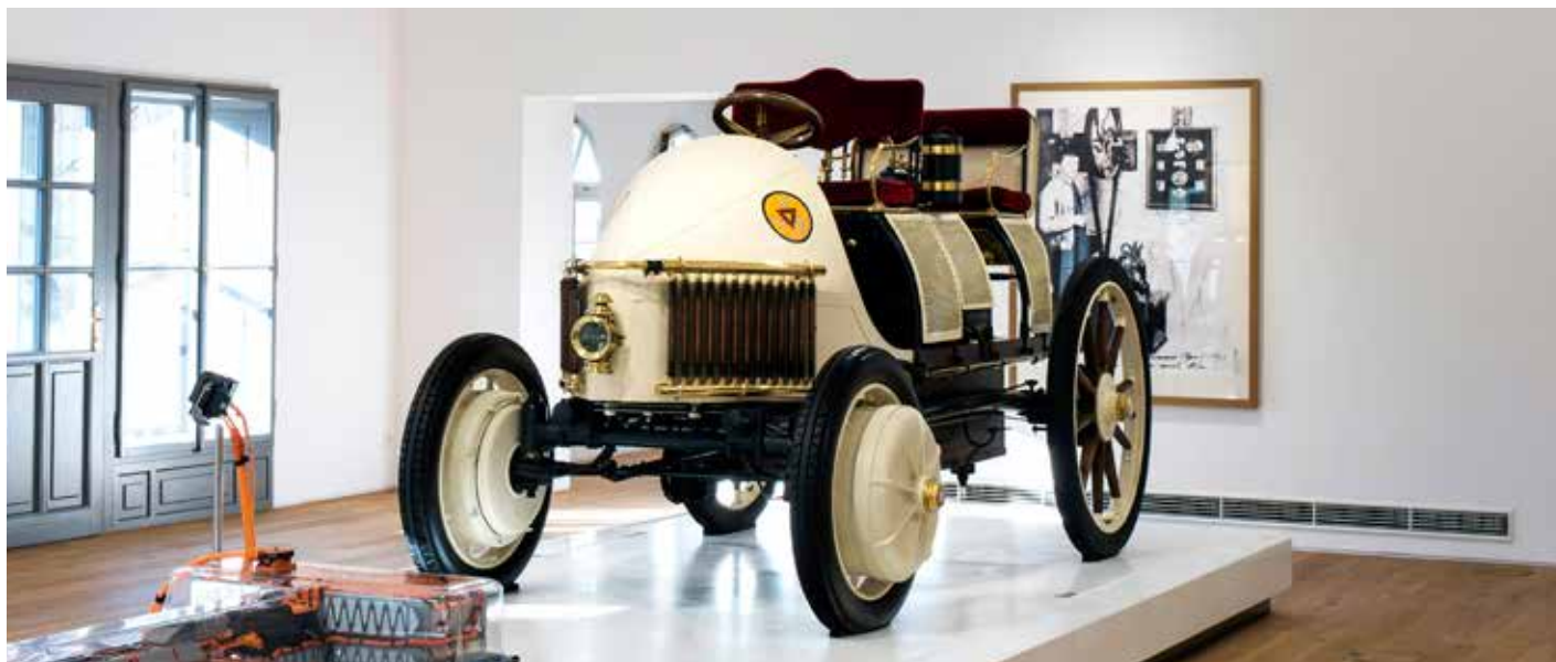
Zdařilá replika vozu Lohner-Porsche „Semper Vivus“ z roku 1900 je jedním z ústředních exponátů. Pohon automobilu zajišťovaly dva nábojové elektromotory na přední nápravě.
