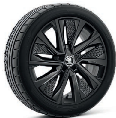
17" kola z lehké slitiny Procyon (černá) s aero kryty disk: 7J × 17" ET51 pneu: 215/45 R17
