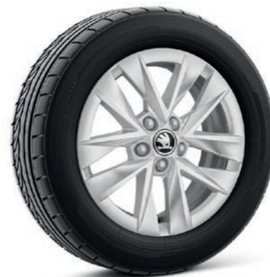
15" kola z lehké slitiny Rotare aero disk: 5,5J × 15" ET40 pneu: 185/65 R15
