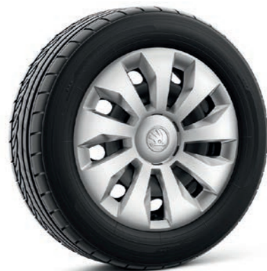
15" ocelová kola s kryty Calisto disk: 5,5J × 15" ET40 pneu: 185/65 R15
